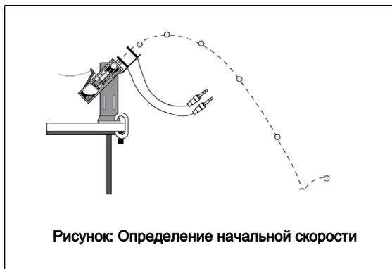
2. Измените угол наклона Баллистического пистолета на любой желаемый. Запишите угол в таблицу 2.1.
