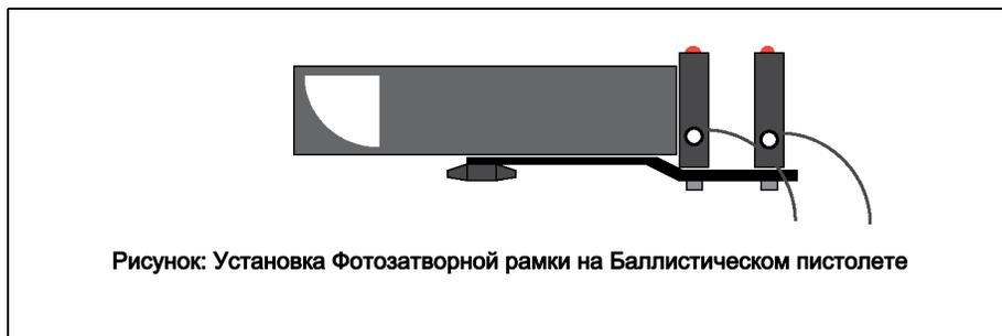
2. Измерьте расстояние между Фотозатворными рамками (если две обычные рамки используются). Вы используете это расстояние и измеренное время пролета между двумя Фотозатворными рамками (или между двумя лучами Сдвоенной Фотозатворной рамки) для расчета начальной скорости снаряда (шарика).
