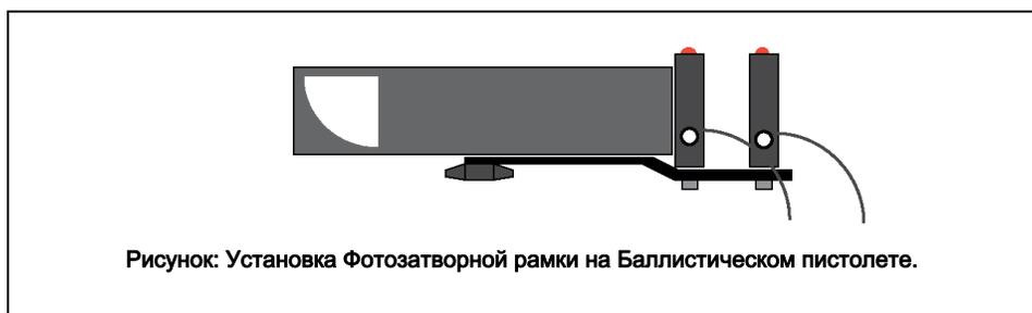
2. Измерьте расстояние между Фотозатворными рамками (если две обычные рамки используются). Вы используете это расстояние и измеренное время пролета между двумя Фотозатворными рамками (или между двумя лучами Сдвоенной Фотозатворной рамки) для расчета начальной скорости снаряда (шарика).
