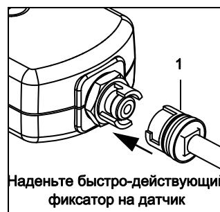
Наденьте быстро-действующий фиксатор на датчик
