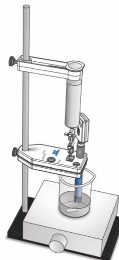
Figure 2: Titration setup
